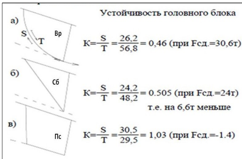
Рис. 2. Типы головных блоков, их сдвигающие (Т) и удерживающие (S) силы, оползневое давление ( F_{сд.} ).
